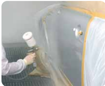
Legg klarlakk på hele området. Pass på at klarlakk legges tynt på i områdene mot tilstøtende deler.
