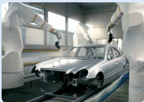
Mekanisk påføring med robot.
